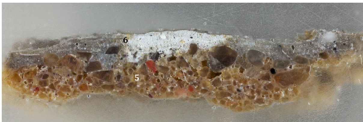
Fot. 40. Przekrój stratygraficzny próbki, którą pobrano zewnętrznych, młodszych chronologicznie warstw, pochodzących najprawdopodobniej z czasu remontu kościoła w latach 1906-1907. Jaśniejszy fragment pośrodku przekroju to część próbki, której nie przesyciła i nie przekształciła kolorystycznie żywica – odcień zbliżony do widocznego w grubości warstwy na murze. Pobiała jest jasnoszara, chłodna w odcieniu. Niewykluczone, że czarne i ugrowe ziarna to niewielki dodatek pigmentów, którymi nieznacznie zabarwiono pobiałą.
